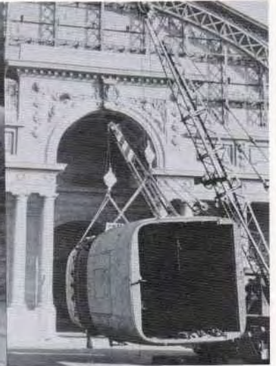
▲ Démontage du « plan central » du C.119. Demontieren van het centrale gedeelte van de C.119.
